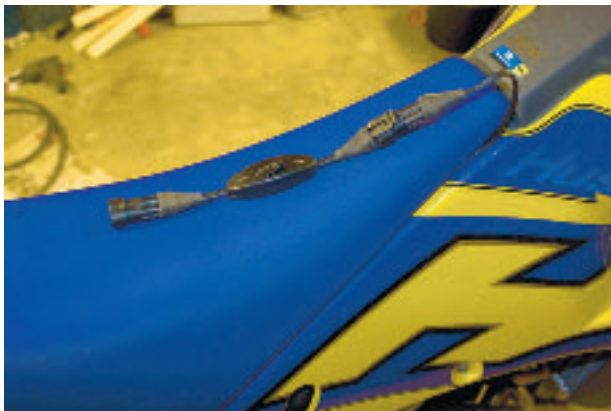
Johto on riittävän pitkä liittimillä, katkaisijalla ja sulakkeella varustettu. Liittimet ovat kosteudelta suojattua mallia, joten sade tai lumi ei aiheuta ongelmia.
